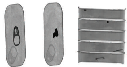
Imagem 4 - Exemplos de detecções de contaminantes metálicos em embalagens de metal
